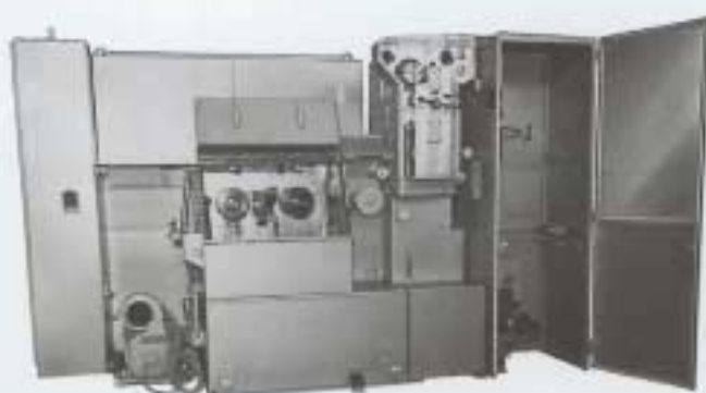
H 20 Ziehmaschine mit Durchlaufglühe und Einzelpulser
