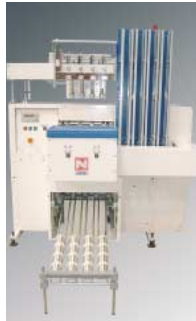
Drahtspulmaschine System Hacoba (links) und BMV-Hochgeschwindigkeits-Flechtmaschine Hacoba System wire rewinding machine (left) and BMV type high-speed braiding machine
